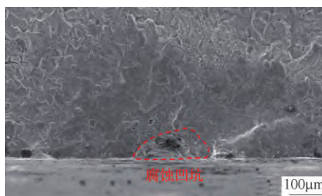
a) 内壁处断口形貌及腐蚀凹坑
