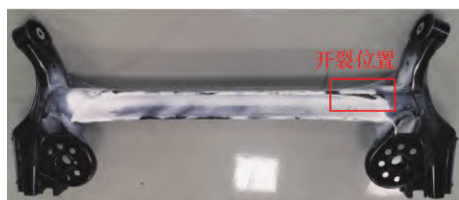
a) 后扭力梁总成及开裂位置
