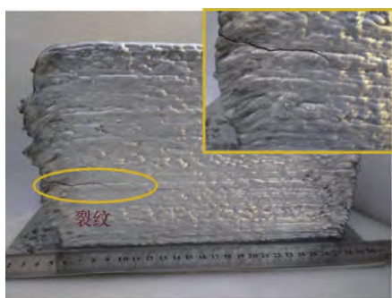
a) 宏观裂纹形貌
