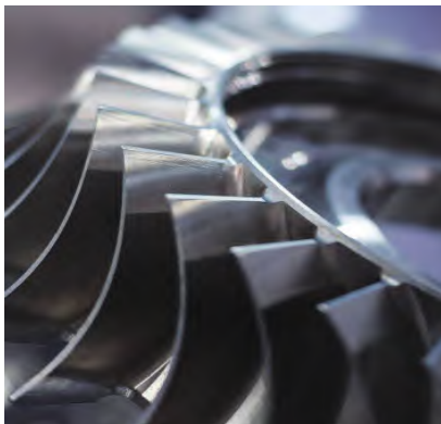
图2 修复后的航空发动机叶片
