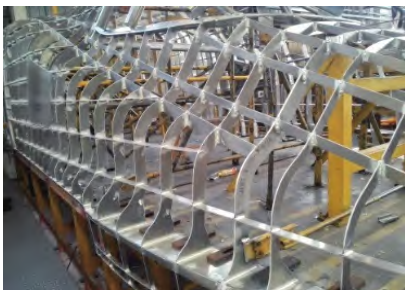
图7 司机室骨架结构及焊接形式
