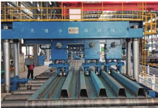
图12 U肋板单元机械矫正
