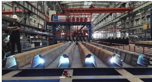
图6 U肋内焊专机设备
