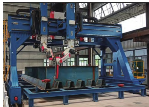
a) 全位置焊接横隔板接板与U肋
