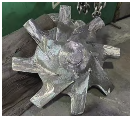
图9 制浆转子铸件毛坯
