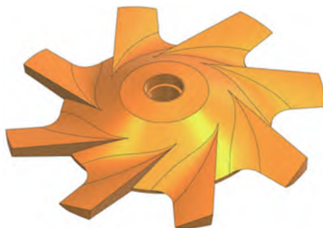
图1 制浆转子三维结构
