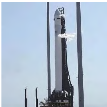
图9 Relativity Space人族1号全3D打印火箭
