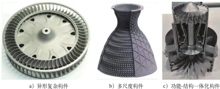
图6 异形复杂/宏-微跨尺度/功能-结构一体化等典型结构
