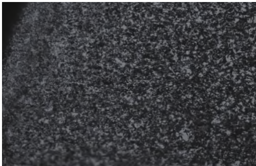
图14 改进后的螺纹表面金相组织(500×)
