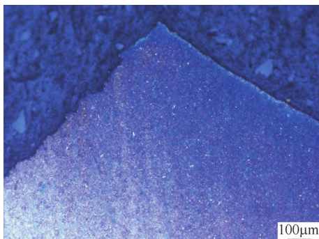
图9 裂纹源处金相组织 (100×)
