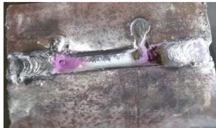
c) 斜Y型坡口焊接裂纹试验 (预热100℃)
