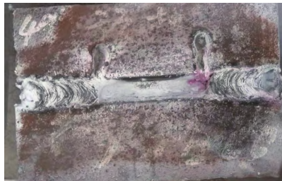
b) 斜Y型坡口焊接裂纹试验 (室温)
