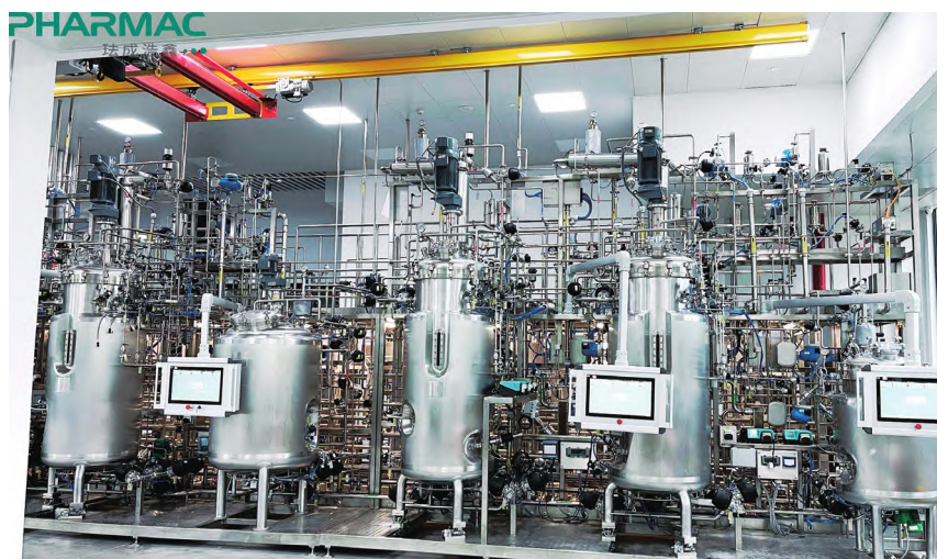
图1 杭州某生物发酵项目 (含 30 L-60 L-150 L-500 L-1000 L 发酵系统三套)
