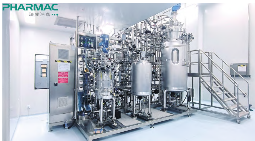
图3 苏州某生物发酵项目 (含 50 L 发酵系统一套及 CIP 系统)
