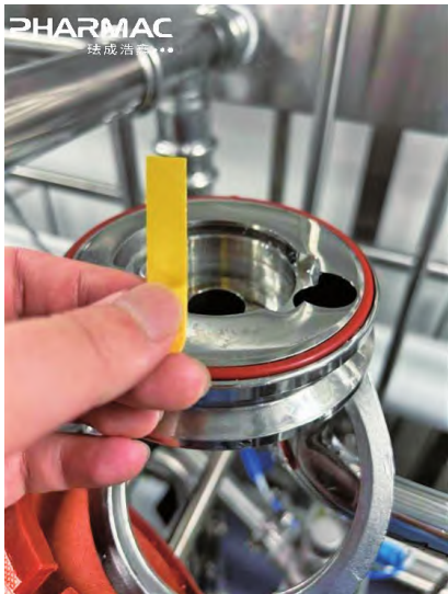
图 4 经过重新测试，使用 pH 试纸对呼吸器内部进行再次检测，结果显示为中性
