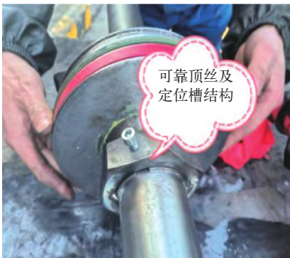
图5 原可靠放松顶丝结构照片
