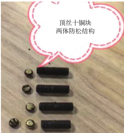
图7 出现问题铜块防松结构照片
