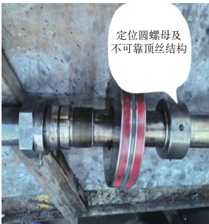
图6 出现问题定位圆螺母及不可靠的顶丝
