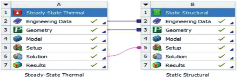
图3 ANSYS Workbench 具体流程设置
