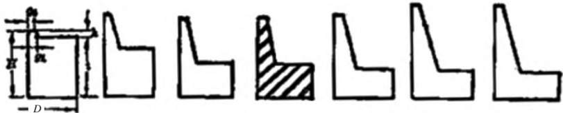
图2 相同法兰力矩下的法兰设计方案图
