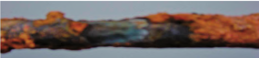
图3 运行10年的 \phi 18\text{ mm} 圆钢直径仅剩12 mm
