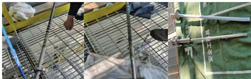
图5 热电偶更换衬玻璃材质前后对比
