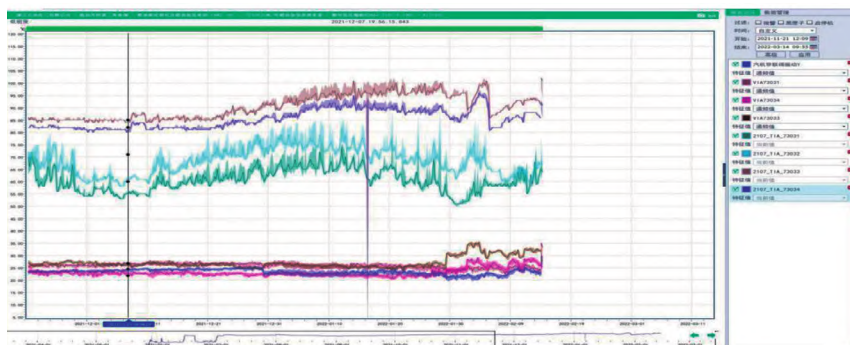
图 1 汽轮机振动随支撑瓦温变化趋势图
