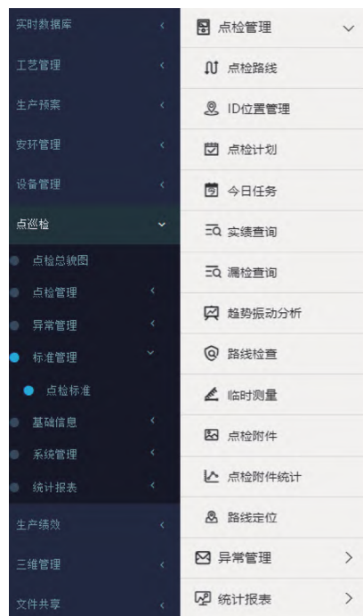
图1 设备管理系统“点巡检”模块界面
