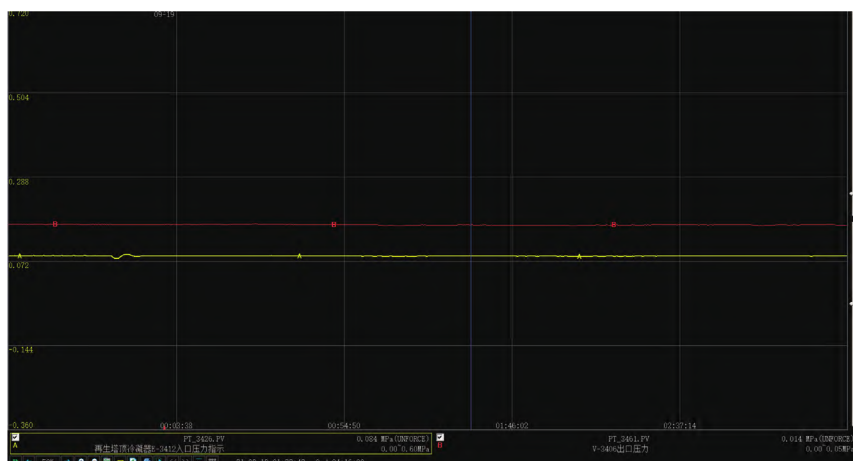
图2 尾气分液罐的压力监测系统压力变送器显示历史趋势
