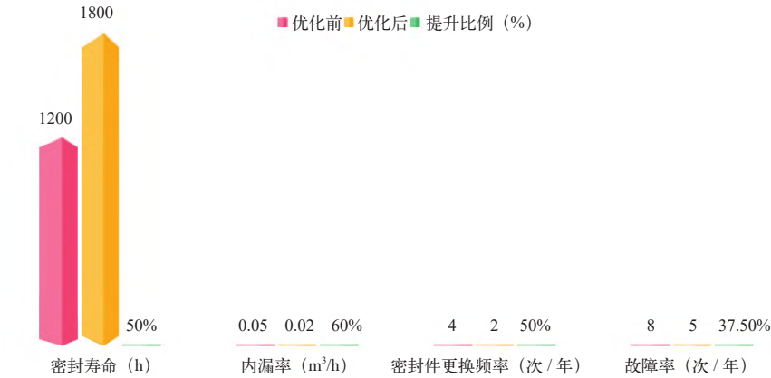
图 3 阀门密封性能优化前后对比
