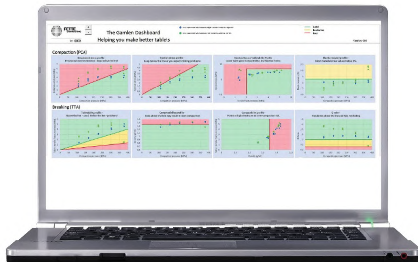
图5 分析软件的仪表盘可快速显示压实度和可压缩性等参数。例如，图表可以将各种物理变量关联起来，以确定最佳压实压力
