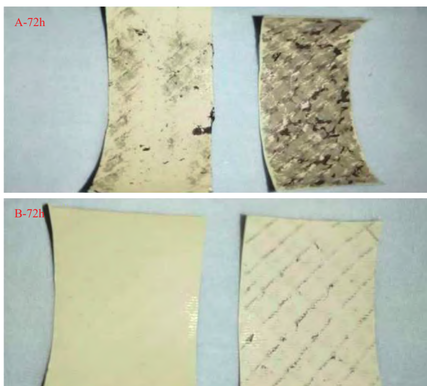
图 2 清洗后污染膜图片 (左侧为碱洗,右侧为酸洗;A、B 为一段第一根膜和二段最后一根膜)
