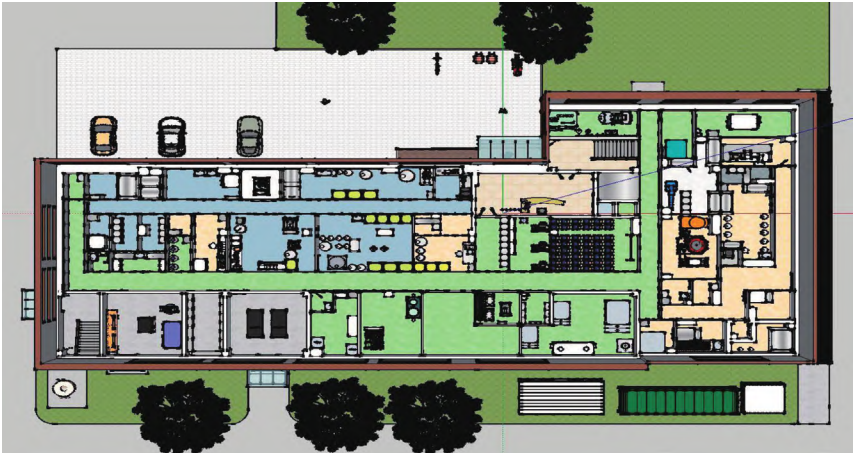
图 1 通过 Sketchup 软件绘制的生物药厂三维模型
