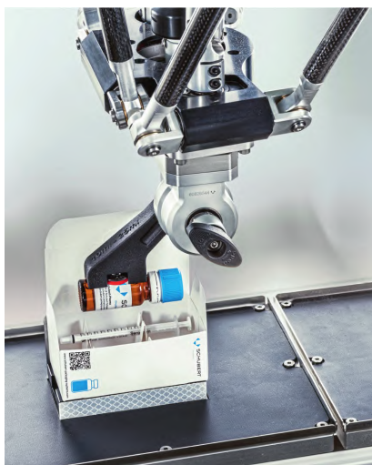
图 1 顶部装载机中的高度灵活机器人不仅能够装载不同数量的产品，例如小瓶，还能装载其他组件，如包装插件
