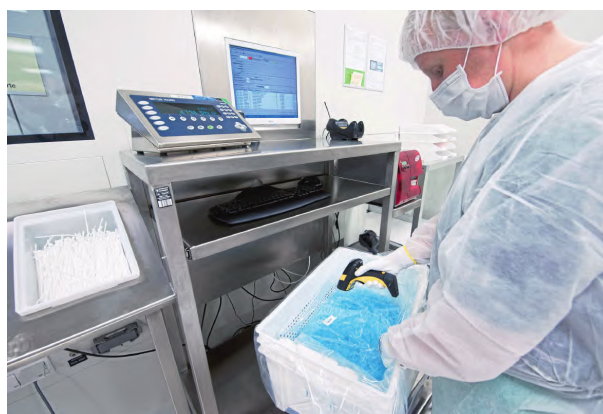
图 2 一名员工正在根据客户的要求，为生产的塑料部件单独进行包装，确保符合最高的清洁度标准，并将它们放置在专用的洁净室袋中
