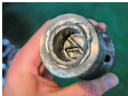
图 2 阀杆疲劳断裂
