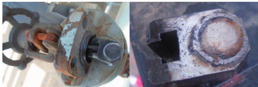
图 1 闸阀闸板密封面损伤
