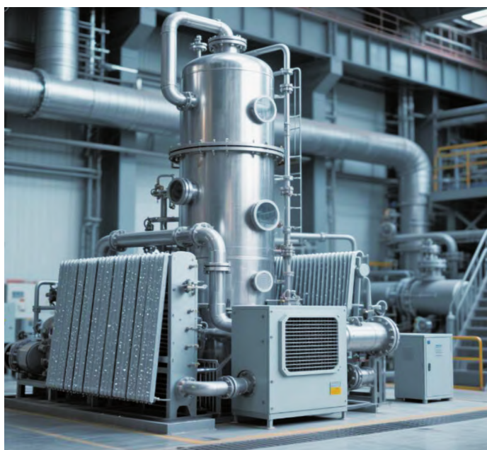
图1 碳四气体脱水冷凝精制装置组件图
