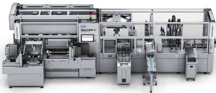
图2 柯尔柏的全纸包装机提供模块化且可扩展的系统,可实现在厂快速改造升级
