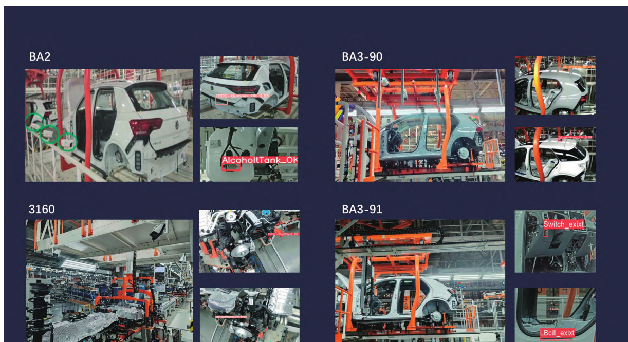
图4 车间多类型视觉检测站
