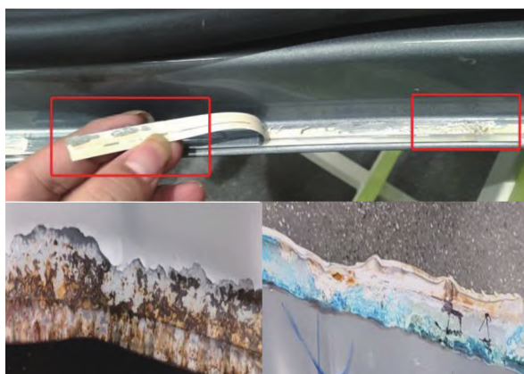
图 2 鼓包处剥离后内外板状态
