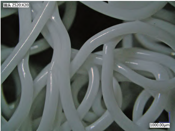
图 1 空气纤维微观结构示意图
