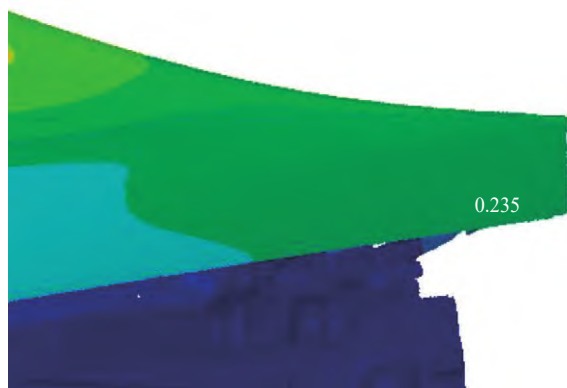
图5 某车型机罩闭合状态时铰链变形 CAE 计算结果
