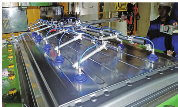
图5 端拾器路径调试
