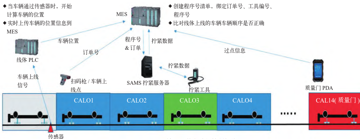
图 3 CAL03 拧紧工艺自动化控制架构
