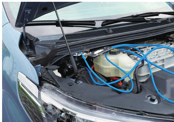
图1 前舱氢浓度传感器布点示意
