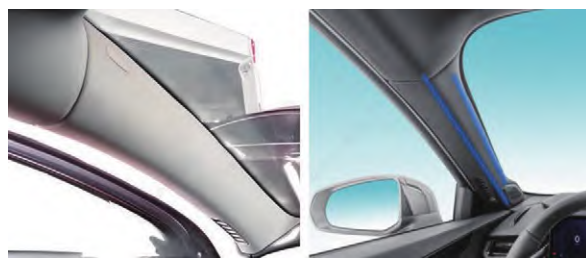
图 1 两款车型 A 柱饰板的设计对比
