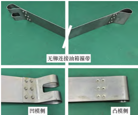
图5 无铆连接箍带及接头外观形貌
