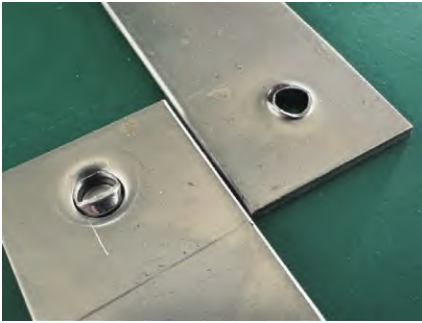
图7 失效无铆连接接头形貌
