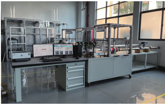
图4 氢燃料电池离心空压机测试系统实物
