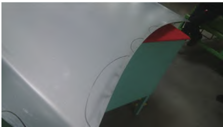
图2 V253车型发动机舱盖表面缺陷位置
