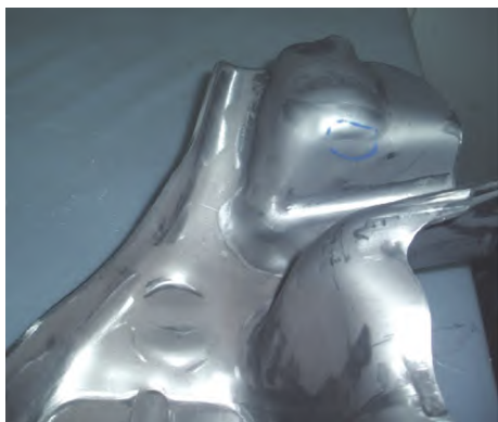
图11 凹坑顶部破裂
