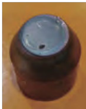
图9 缺陷电极帽示意图
