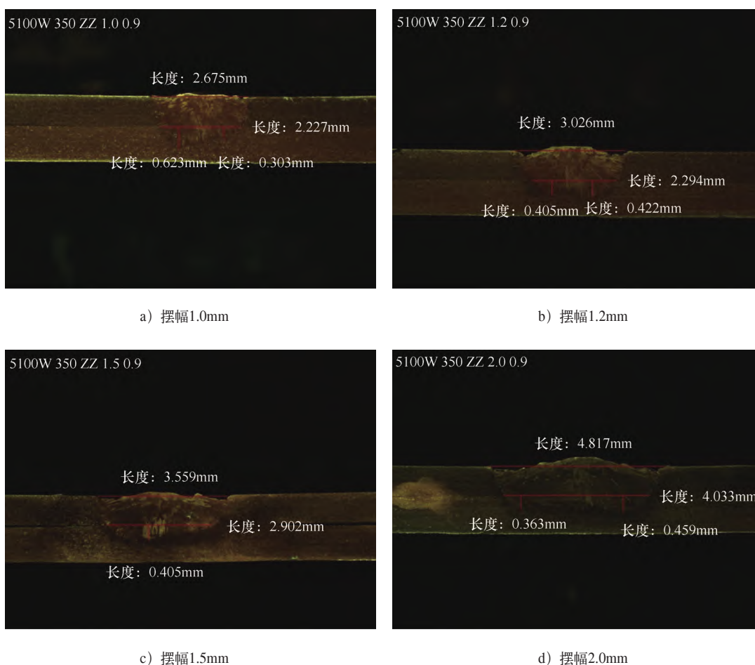
图5 不同摆幅金属铜焊接金相结果
