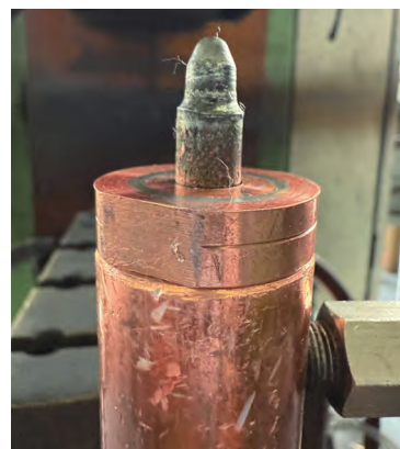
图4 合金凸焊定位销磨损状态
