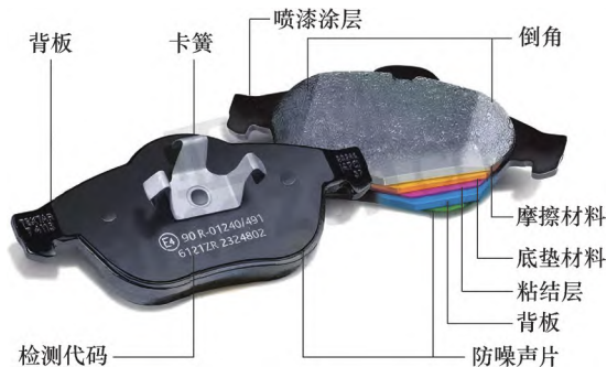
图1 新型复合材料刹车片分层结构示意图
