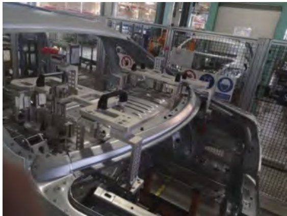
图8 行李舱铰链工装装配
