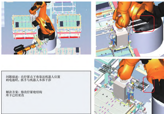
图6 动态仿真工艺干涉检查
