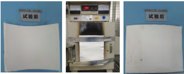
图6 隔热效率和降温速率试验前、过程中、试验后图片
