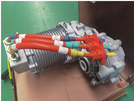
图3 采用飞溅润滑的减速器样机
