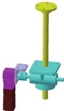
图4 电动丝杆-减速机联轴器组件示意
