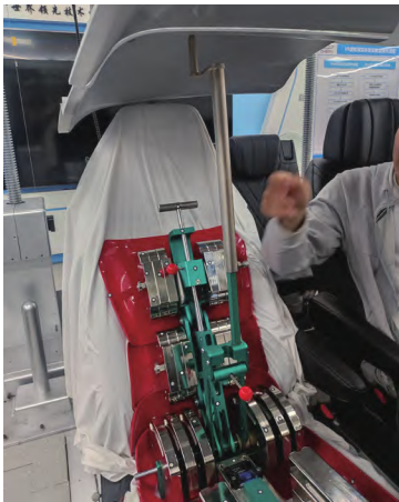
图15 三维H点装置测量头部空间
