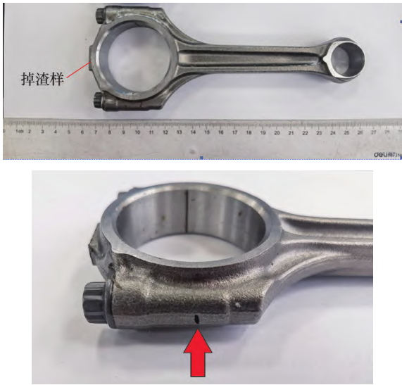
图1 掉渣样宏观形貌
