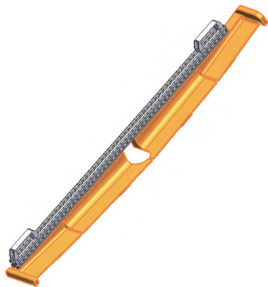
图5 左侧围外板辅助压紧工具
